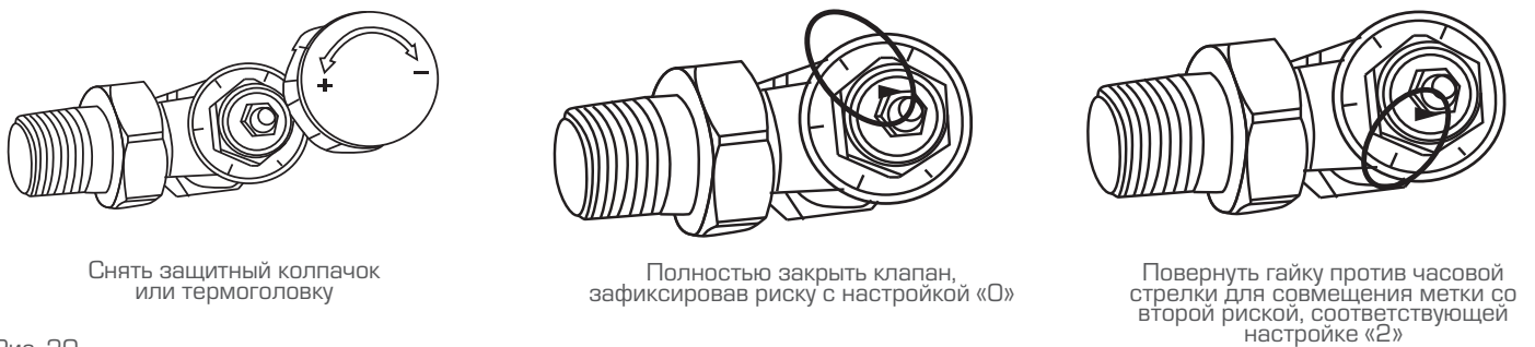
Рис. 20. Пример преднастройки клапана терморегулятора
