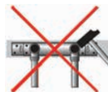
Фасонные части нельзя выправлять молотком
