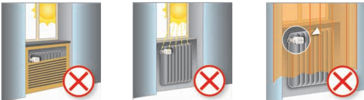
Рис. 8. Требования по размещению автоматического терморегулятора
