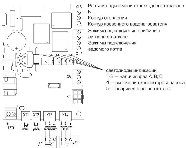
Рис. 5. Расположение разъемов на плате контроллера
