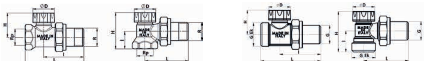
Рис. 31. Устройство запорно-балансировочного клапана типа SVL
